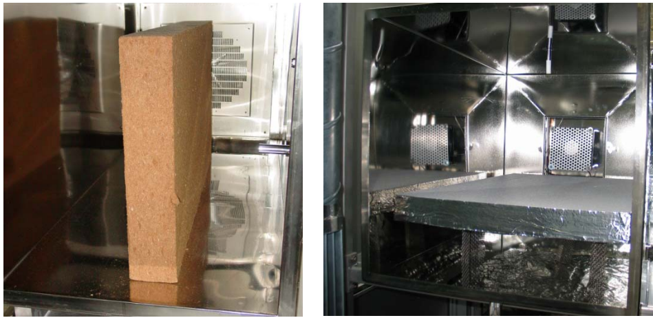
Bild 3: Dämmstoffe in der Emissionsprüfkammer
