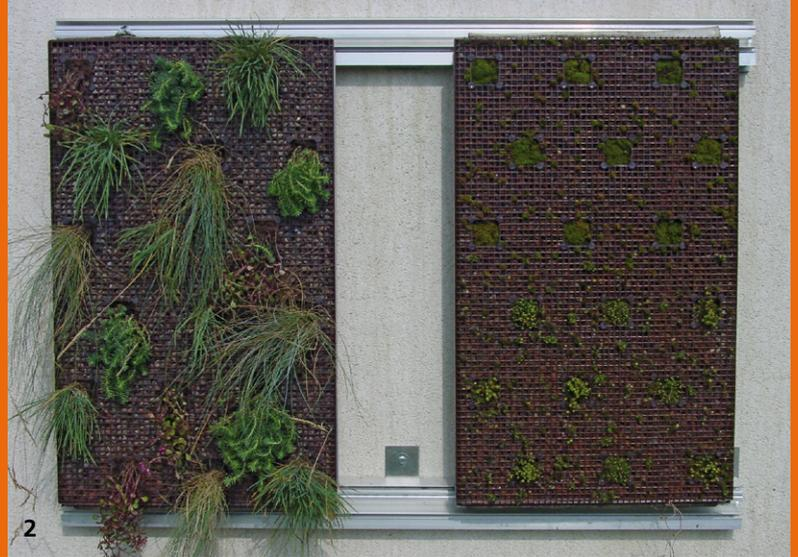
Alle Prüfkörper stimmen in ihrem Aufbau überein – sie variieren durch ihre Substratschichtdicke, das verwendete Substrat und die Vegetation.
