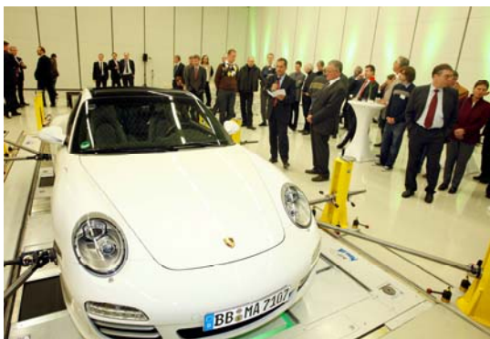
Bild 1: Akustikmesshalle des Fraunhofer-Instituts für Bauphysik mit Testfahrzeug.
