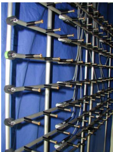
96 hochpräzise Mikrofone auf einem Array angeordnet und mit einem Analysator verbunden.
