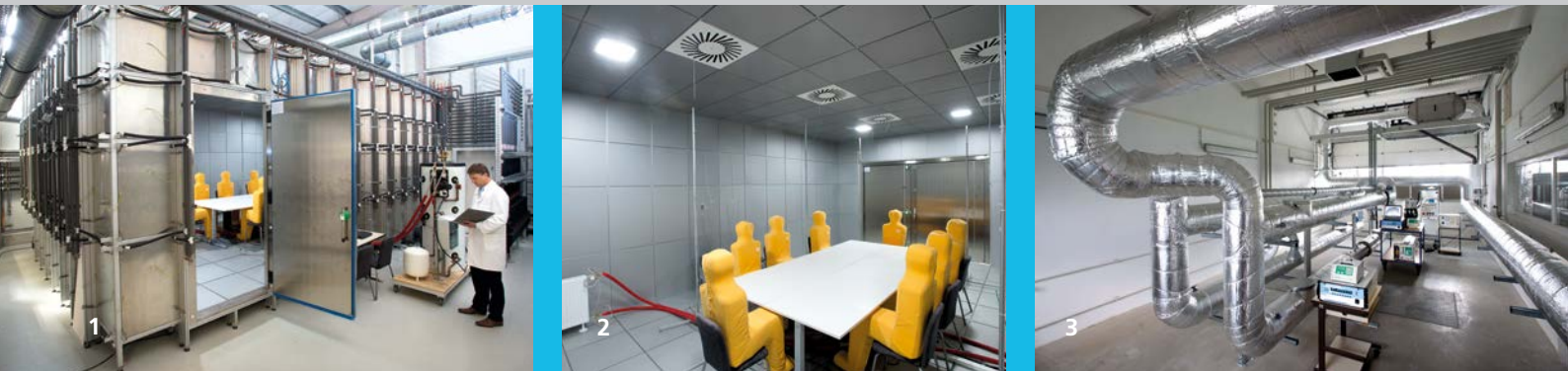
1 Prüfraum außen mit modularen Heiz-/Kühlfeldern
