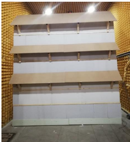
Bild 24: Links: Messaufbau der LSW mit drei Reihen von PV-Modulen im Halbfreinfeldraum nach DIN EN 1793-5. Rechts: Vergleich der Messergebnisse mit denen der LSW ohne PV.
