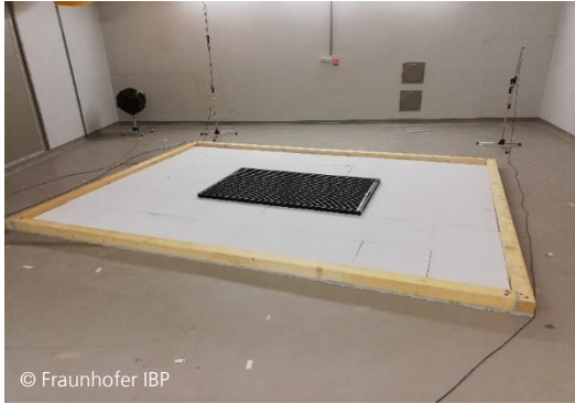
Bild 17: Links: Muster einer schallabsorbierenden Lärmschutzwand. Rechts: gemessene Schallabsorption im Vergleich zu den Anforderungen nach DB RIL 804.5501.
