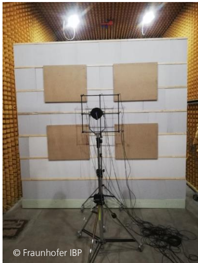
Bild 23: Links: Messaufbau einer 4 x 4 m großen, hochabsorbierenden Lärmschutzwand mit vier PV-Modulen (24 % Flächenbelegung) mit Mikrofonarray im Halbfreinfeldraum nach DIN EN 1793-5. Rechts: Vergleich der Messergebnisse mit dem Verfahren nach DIN EN 1793-1 im Hallraum.
