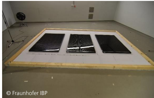
Bild 18: Muster einer schallabsorbierenden LSW aus absorbierender Fläche. Links: mit 2 PV-Modulen entsprechend einer Belegung von 24%. Rechts: mit 3 PV-Modulen entsprechend einer Belegung von 36%.
