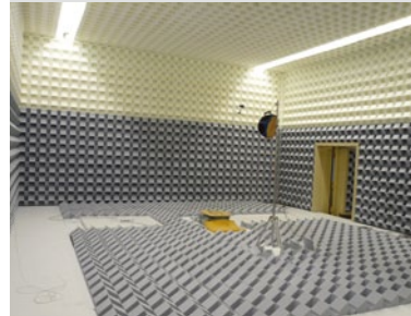
Akustischer Messraum mit asymmetrischen Strukturabsorbem
