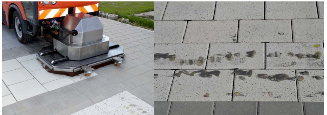
Bild 2.6: Intensivreinigungs-Prototyp der Fa. Metras (links) und Resultat der Intensivreinigung auf Kaugummis (rechts).
