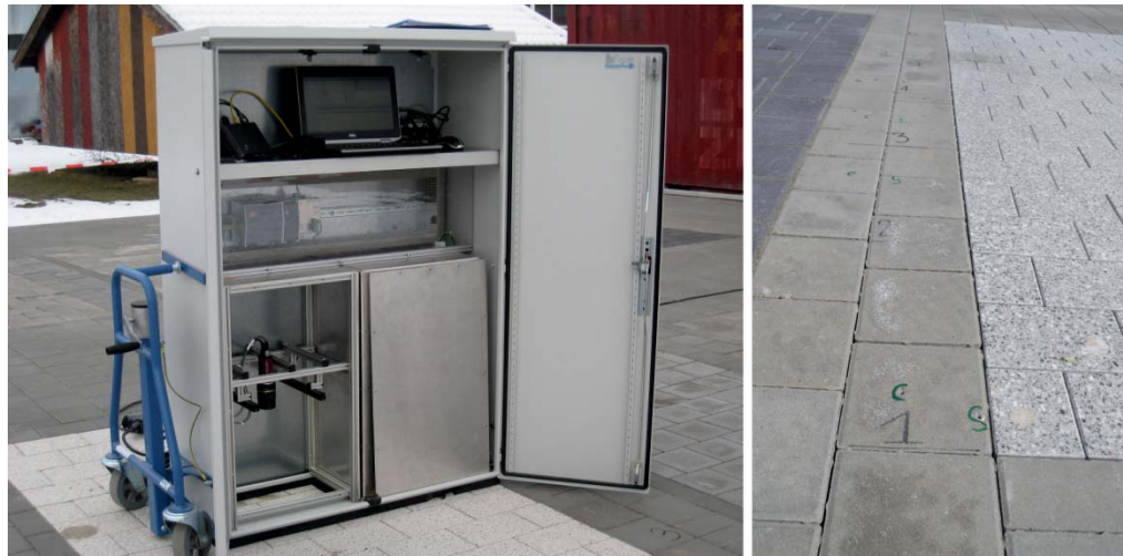
Bild 2.8: Mobile Einheit mit 3D-Scanner und Kamera (links) und Markierungen für Positionierung der Einheit (rechts).
