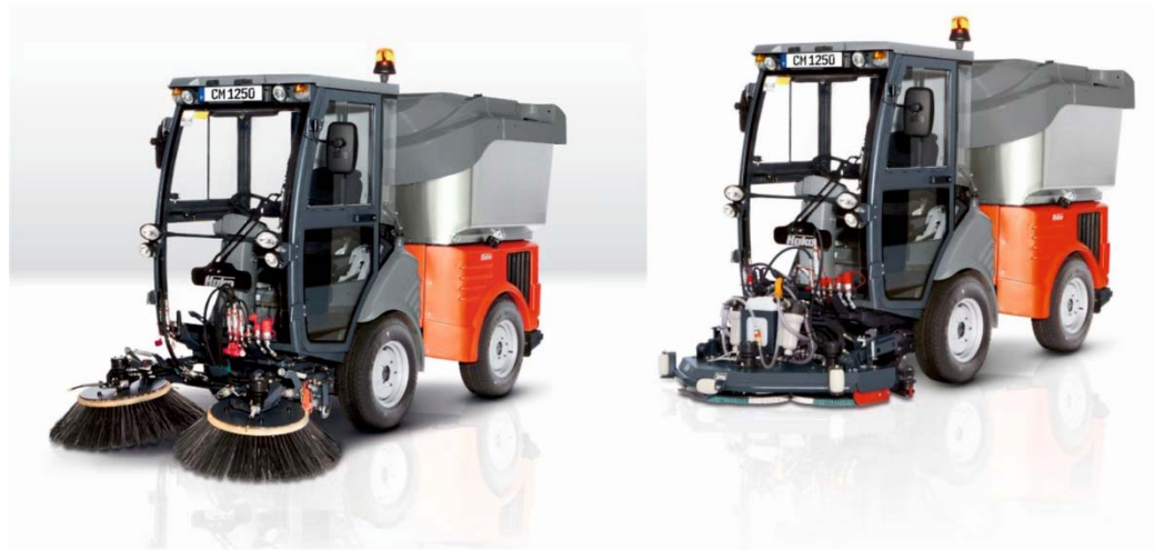
Bild 2.4: Reinigungsfahrzeug mit Trockenkehrreinheit (links) und Schrubbdeck zur Nassreinigung (rechts).
