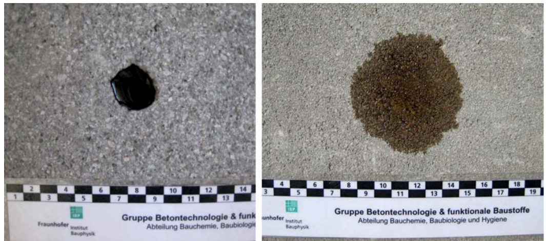
Bild 3.8: Ölfleck auf Pflasterstein mit geschliffener, gestrahlter und beschichteter Oberfläche (links) und betonglatte Oberfläche (rechts) etwa zehn Minuten nach dem Auftropfen.
