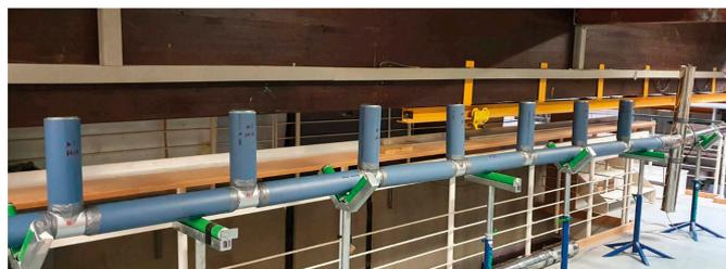
**Bild 7** Versuchsaufbau zur Validierung des periodischen Einheitszellenverbundes mit sieben  $\lambda/4$ -Resonatoren
