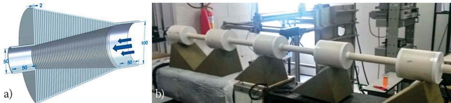
**Bild 2** a) Rohrschalldämpfer mit einem Array von  $\lambda/4$ -Resonatoren [6] und b) periodische Anordnung von Expansionskammer-Schalldämpfern [8]
