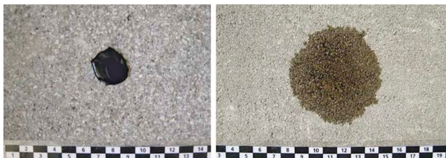
Bild 10. Ölfleck auf einem Pflasterstein mit beschichteter Oberfläche (links) und unbehandelter Oberfläche (rechts) etwa zehn Minuten nach dem Aufbringen.
