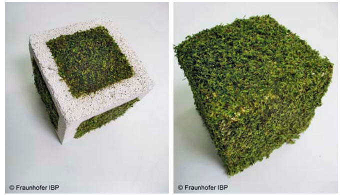
Bild 5. Dreidimensionale Prüfkörper aus mineralischen Baustoffen und mit Moos begrünt.
