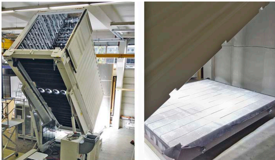
Bild 4. Versuchseinrichtung zur praxisnahen Erwärmungs- und Verdunstungsprüfung von hydroaktiven Bauwerks-oberflächen bei variablen sommerlichen Randbedingungen. (links: Sonnensimulator bei 60 Grad Sonnenhöhenwinkel, rechts: Versuchsfläche)
