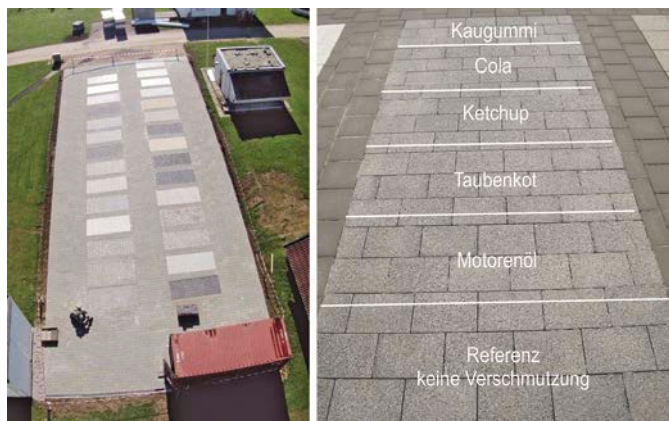
Bild 9. Versuchsfläche mit 30 verschiedenen Testflächen auf dem Freilandversuchsgelände des Fraunhofer-Instituts für Bauphysik IBP (links) und Beispielflächen mit schematischer Schmutzverteilung (rechts)
