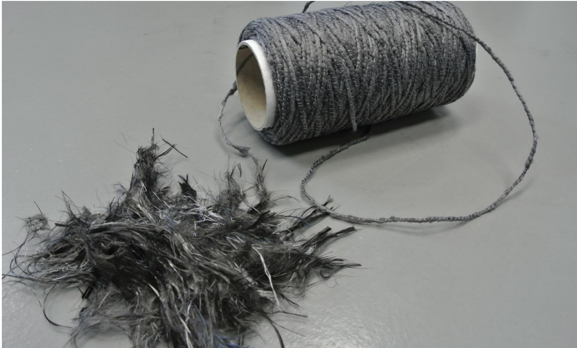
Abb. 1: Tastversuch zur Fertigung von Fasern und Garnen aus recycelten Fasern
