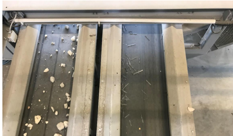
Abb. 4 bis Abb. 6: Sortierung von carbonbetonhaltigen Bruchmaterialien bzw. sekundären Wertstoffen
