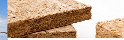
Typhaboard serves both load-bearing and insulating purposes with a single layer of construction material. © Bayerisches Landesamt für Denkmalpflege, Chr. Grube
